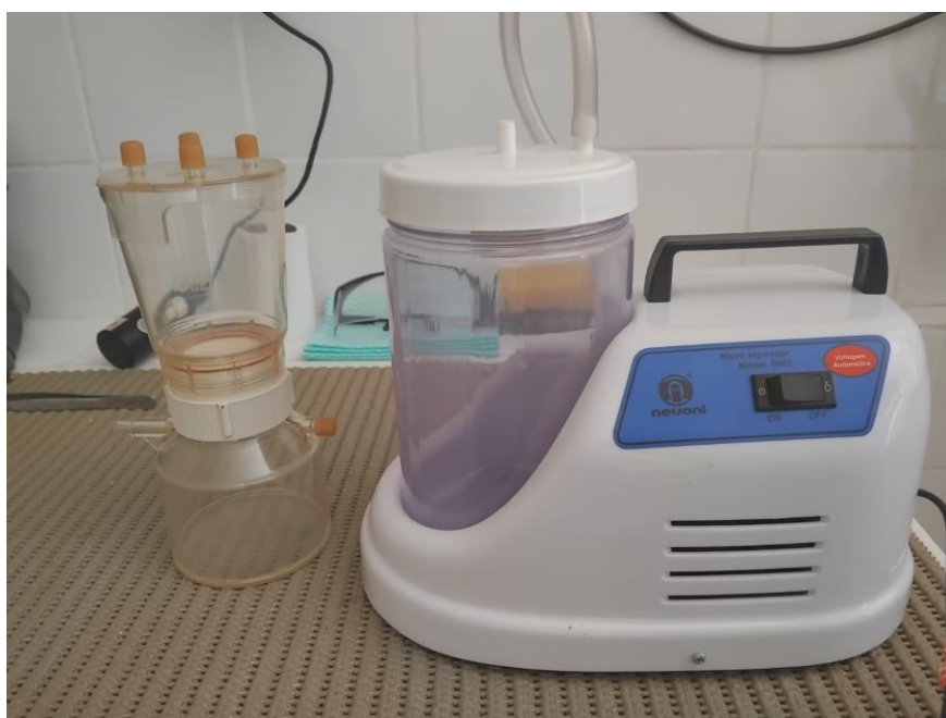
Figura 6-Filtração utilizando bomba a Vácuo para análise gravimétrica. Fonte: autoral
