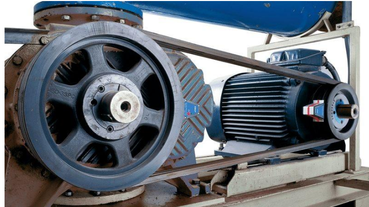
Figura 1.5 – Exemplo do conjunto polias e correia para transmissão de potência. Fonte: ABECOM, https://www.abecom.com.br/polia-industrial/ . Acessado em: 05/05/2024, às 23:43.
