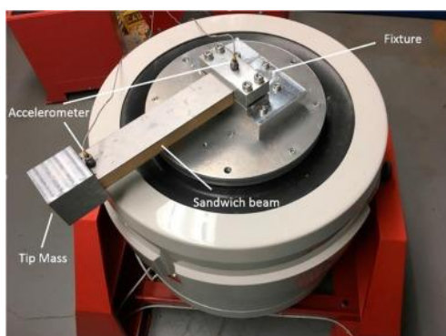
Figura 1.8 – Exemplo de aplicação de um sensor piezoelétrico. Fonte: BARRY et al. (2019).
